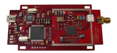
Модуль ридера **RMA900-16** является элементом считывателей RFID российского UHF диапазона. Он предназначен для использования в малогабаритных считывателях RFID меток.
